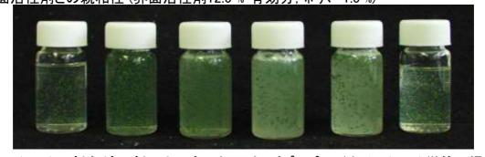
SLES(2モル)の割合が8.5割以上のものと、コカミドプロピルベタイン(CAB)単体の場合で透明のゲルが得られる。また溶液が濁った場合でも降伏値は維持できる
