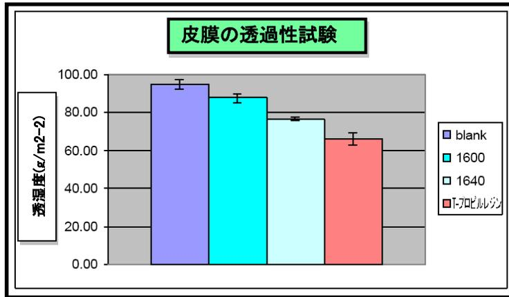
●T-プロピルレジンの比率が高いほど、透過性が低下し、閉塞性が向上する。
