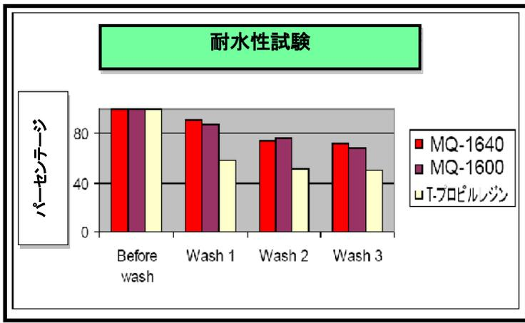
●MQ-1600 とMQ-1640 は 3 回の耐水性試験で同様の結果を示し、ともに約 **70%の耐水性**を示した。
