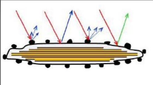
表面のステップ(段差)により、光が様々な方向へ乱反射します。
