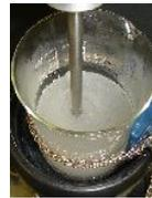
60°Cに加温した精製水へ、分散物をゆっくり添加する。(D=2500rpm)・・・回転数は、全体を巻き込むような強さで！
