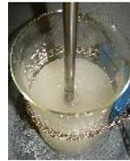
(D=3500rpm)・・・回転数は、全体を巻き込むような強さで！
