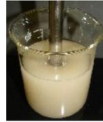
混合物をディスペーにて攪拌分散する(D=1000rpm)但し、分散するのみで溶解しない(湿潤)
